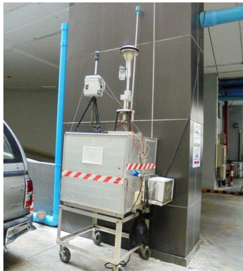
ภาพที่ 6 ตรวจวัดฝุ่นละอองและก๊าซมลพิษ CO SO 2 NO 2 HC
